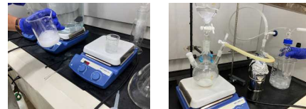
炭素14の捕集実験の様子
