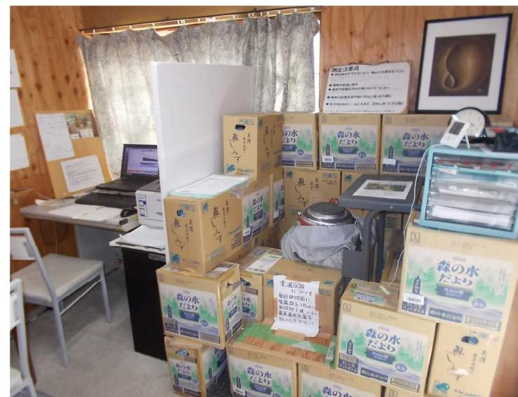
屑鉛を購入して遮蔽剤の補強をして、総重量は200kg超さらに、ミネラルウォーター2L x 6本入りを40ケース積み上げている。このことによって、NaIセンサーの温度変化が小さくなり、エアコンを使わなくても1200分間の温度変化が3℃以内に維持されることがわかった。
